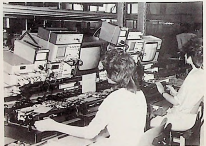
Bild 1: Prüfplatz für die Erstinbetriebnahme der Videorecorder
