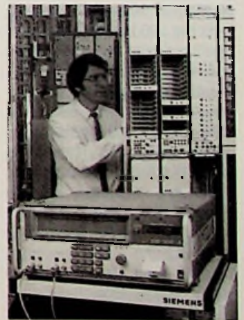
Bild 1: Bitfehlermeßgerät für pulscodemodierte Übertragungsstrecken (Siemens-Pressbild)
