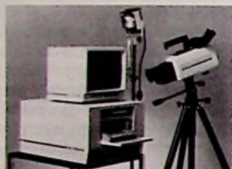
Bild 1: Video-System für die Hochgeschwindigkeits-Analyse (Kodak-Pressbild)
