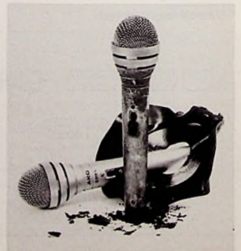
Bild 1: Gibt auch nach Discobrand noch Töne, das Mikrofon D310 (AKG-Pressbild)
