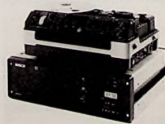
Bild 1: Zusammen mit der Magnetbandaufzeichnungsmaschine BCN 21 schafft der Prozessor BC PC 921 eine hochwertige Wiedergabeeinheit (Bosch-Pressbild)
