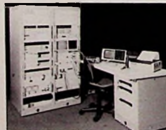
Bild 1: Automatisches Testsystem TS 8500 für Meßaufgaben an AM-, FM-, \phi M- und SSB-Funkgeräten im Frequenzbereich 0,1 bis 2720 MHz (Rohde & Schwarz-Pressbild)
